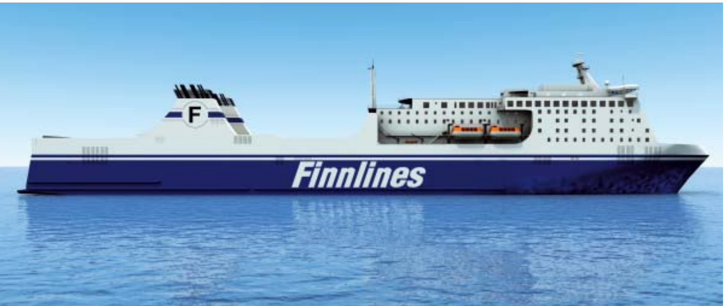
NB 1-5 (2005-2007) Alukset ovat suurimpia ja kokoluokassaan nopeimpia koskaan rakennettuja ropax-aluksia. 4 200 kaistametriä, 500 vuodepaikkaa, nopeus 25 solmua, rakennetaan Italiassa.
