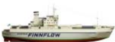
MS Finncarrier (1969-1975) roro rahti/matkustaja-alus, 1000 kaistametriä, 36 vuodepaikkaa, nopeus 18 solmua, rakennettiin Suomessa.
